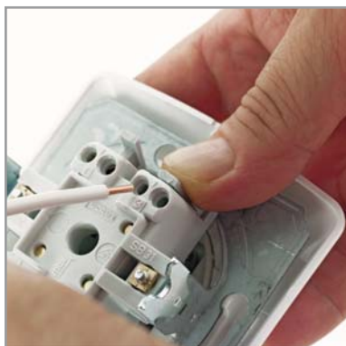
Bezskrútkové, rýchle a bezpečné pripojenie až do prierezu 2,5 mm 2 (aj pre priebežné zapojenie)
